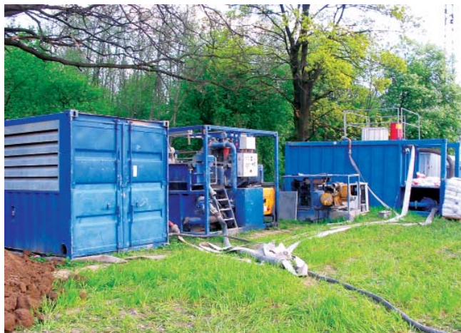
Fot. 3. System recyklingu płuczki
