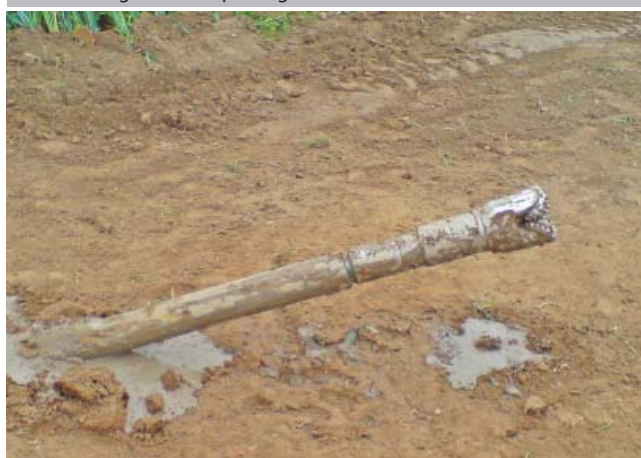
Fot. 2. Silnik w głębnym po wyjściu z otworu
