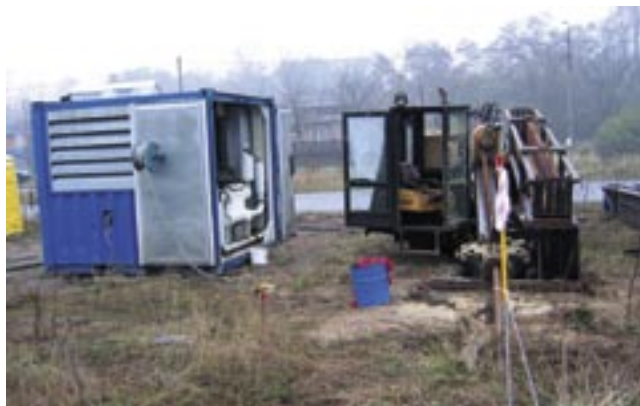
Bydgoszcz - jedna z tajemnic sukcesu, wiertnica 22 tony i pompa płuczkiowa 1000l./min
